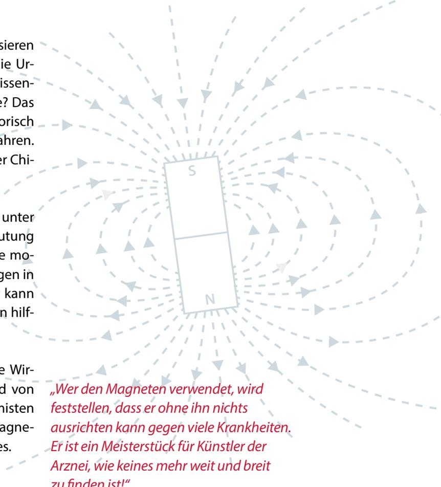
Das Diagramm zeigt einen rechteckigen Magneten mit den Polen 'S' (Südpol) oben und 'N' (Nordpol) unten. Von den Polen gehen gestrichelte Linien aus, die die magnetischen Feldlinien darstellen. Diese Linien verlaufen von den Polen nach außen und bilden dabei spiralförmige Schleifen, die die Richtung der magnetischen Kraft anzeigt. Die Linien sind durch Pfeile angedeutet, die die Ausbreitungsrichtung zeigen.
